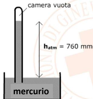
Misura definita da Torricelli pesando la colonna di 76 cm di mercurio nel tubo omonimo
