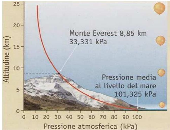
Sull'Everest una pompa centrifuga andrebbe in cavitazione con un pescaggio inferiore ai 2-2,5 metri
