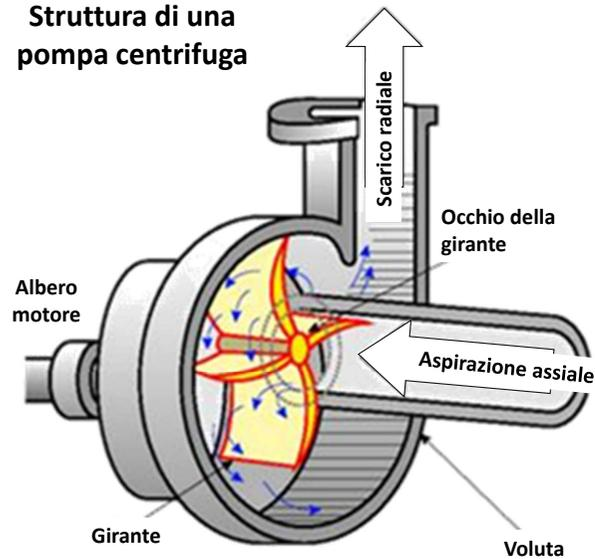
**GIRANTE:** è l'elemento principale della pompa. La tipologia dipende anche dalle caratteristiche del liquido. La curvatura delle palette nelle giranti moderne è rivolta nella direzione opposta al flusso. Questo consente pressioni maggiori e perdite di carico minori.
