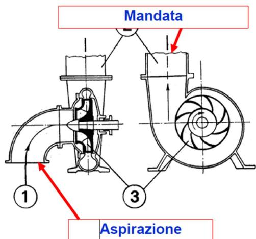
Una pompa centrifuga è composta essenzialmente da una parte rotante detta girante e da una parte fissa, o corpo della pompa, entro cui si muove l'acqua convogliata dalla forza centrifuga impressa dalla girante. L'acqua entra nella pompa attraverso il tubo di aspirazione e viene inviata, attraverso il movimento della girante, nel tubo di mandata. Il tubo di aspirazione è assiale rispetto alla girante, il tubo di mandata è radiale.
